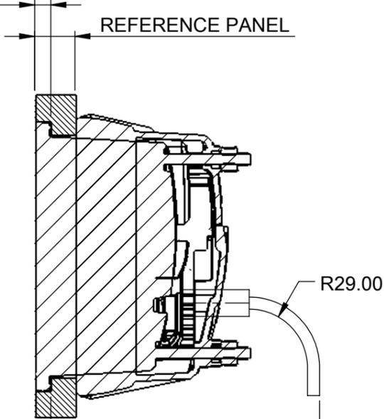
FOR STRAIGHT CABLE THE MINIMUM CLEARANCE = 210.00
