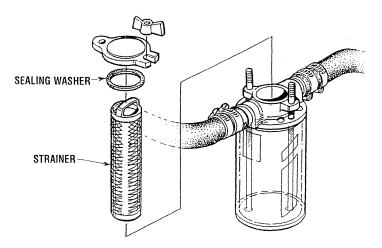
RAW WATER INTAKE STRAINER OWNER INSTALLED (TYPICAL)
