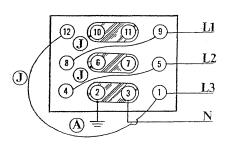
L-N - 120 VAC 10 60 Hz L-N - 110 VAC 10 60 Hz L-L - 450 VAC 3Ø 60 Hz
