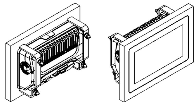
FOR STRAIGHT CABLE THE MINIMUM CLEARANCE = 170mm
